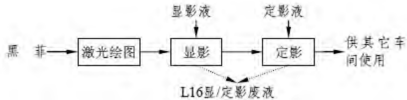
图 4-17 菲林制作工艺流程及产污环节图
