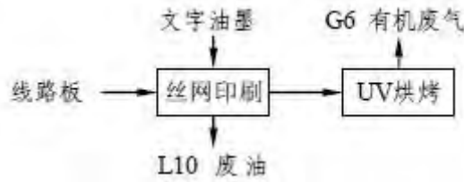
图 4-16 文字印刷工艺流程及产污环节图
